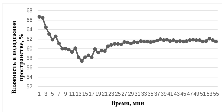
Рисунок 3. Изменение влажности в пододежном слое пакета, состоящего из ткани верха, утепляющей прокладки («Холофайбер») и подкладки, при T = 26^{\circ}\text{C} ; W = 22\% .
