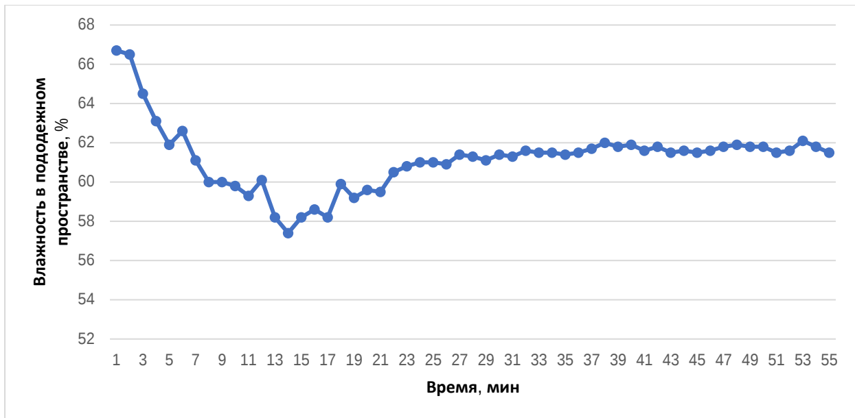
Рисунок 4.6 - Изменение влажности в пододежном слое пакета 1, при параметрах окружающего воздуха: T = 27^{\circ}\text{C} ; W = 22\%
