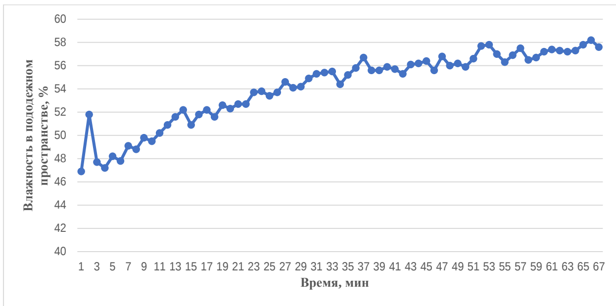
Рисунок 4.7 - Изменение влажности в пододежном слое пакета 2, при параметрах окружающего воздуха: T = 27^{\circ}\text{C} ; W = 16\%
