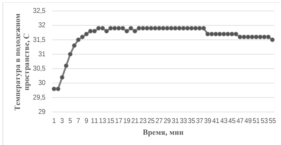
Рисунок 4. Изменение температуры в пододежном слое пакета, состоящего из ткани верха, утепляющей прокладки («Холофайбер») и подкладки, при T = 26^{\circ}\text{C} ; W = 22\% .
